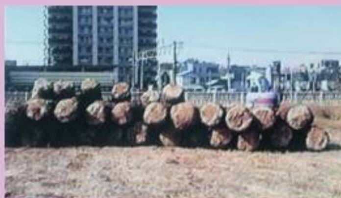
伝寺領から出土した明治の八幡宿駅工事遺構、 当時最新技術のコンクリート杭
